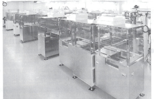
写真5 ロータ、搬送、回転、アンローダモジュールを連結
